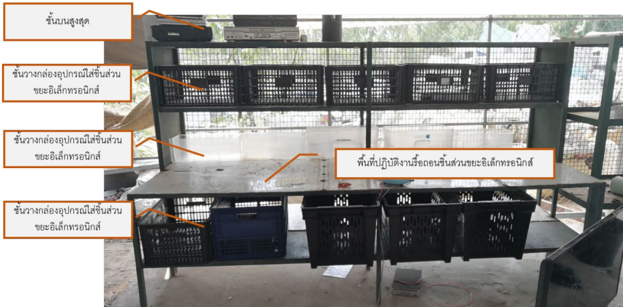
รูปที่ 3 โตะที่ใช้ในการรื้อถอนชิ้นส่วนขยะอิเล็กทรอนิกส์
