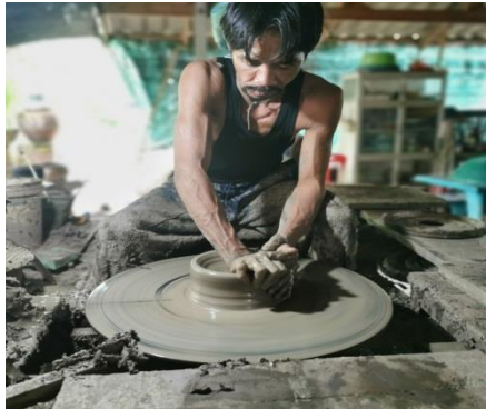
ภาพที่ 1 การขึ้นรูปโดยใช้แป้นหมุนไฟฟ้า ที่มา : นราธิป ภักดีจันทร์, (2563), ถ่ายภาพ
