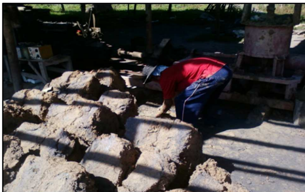
ภาพที่ 3 การนำวัตถุดิบเข้าเครื่องไม้และอัด
