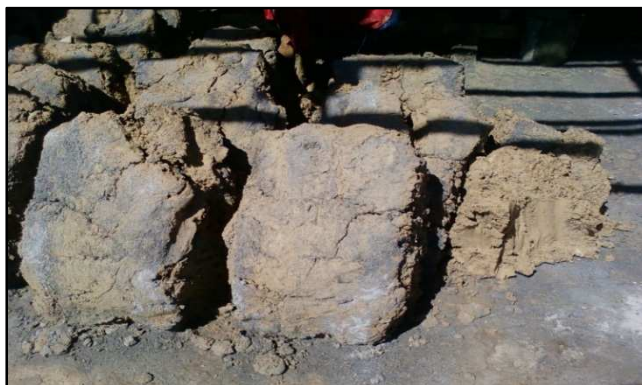
ภาพที่ 2 วัตถุดิบในการผลิตอิฐมอญที่หมักผสมตามสูตรและขนาดเสร็จเรียบร้อยแล้ว
