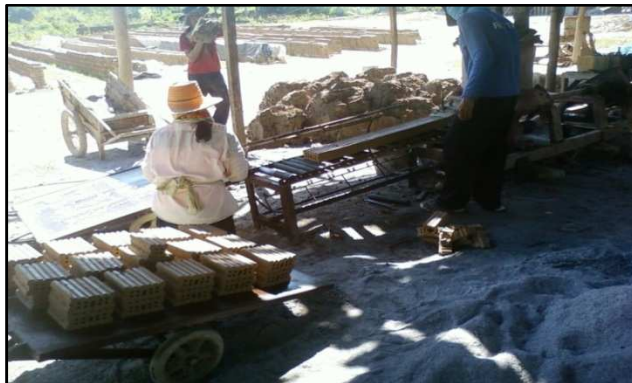
ภาพที่ 6 จัดวางอิฐใส่รถเข็นเพื่อเคลื่อนย้ายไปตาก
